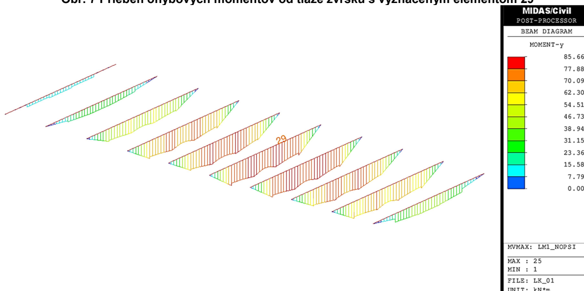
Obr. 8 Priebeh ohybových momentov od pohyblivého zaťaženia LM1 s vyznačeným elementom 29
